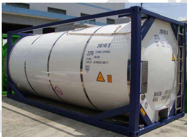
Tanques Portáteis que se enquadram na definição de contêiner
