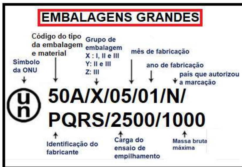
FIGURA 16 – Exemplo do significado das informações constantes na marcação ONU para embalagens grandes
