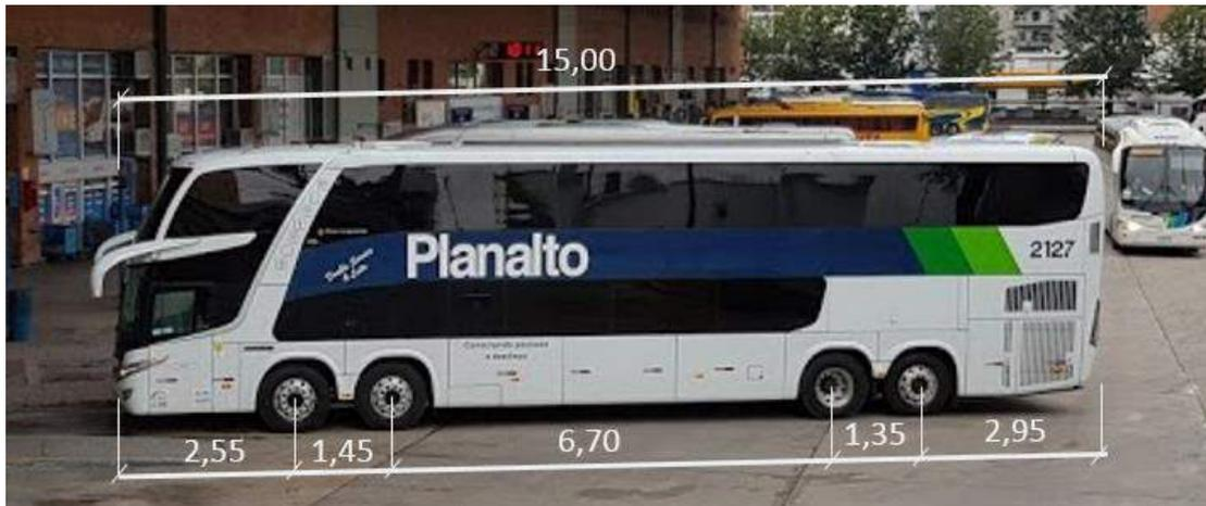
Figura 1 - Dimensiones del ómnibus. Medidas en metros.
