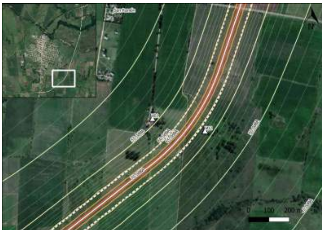
Figura 4-34: NPS aportado por el emprendimiento para V01 a V02.
