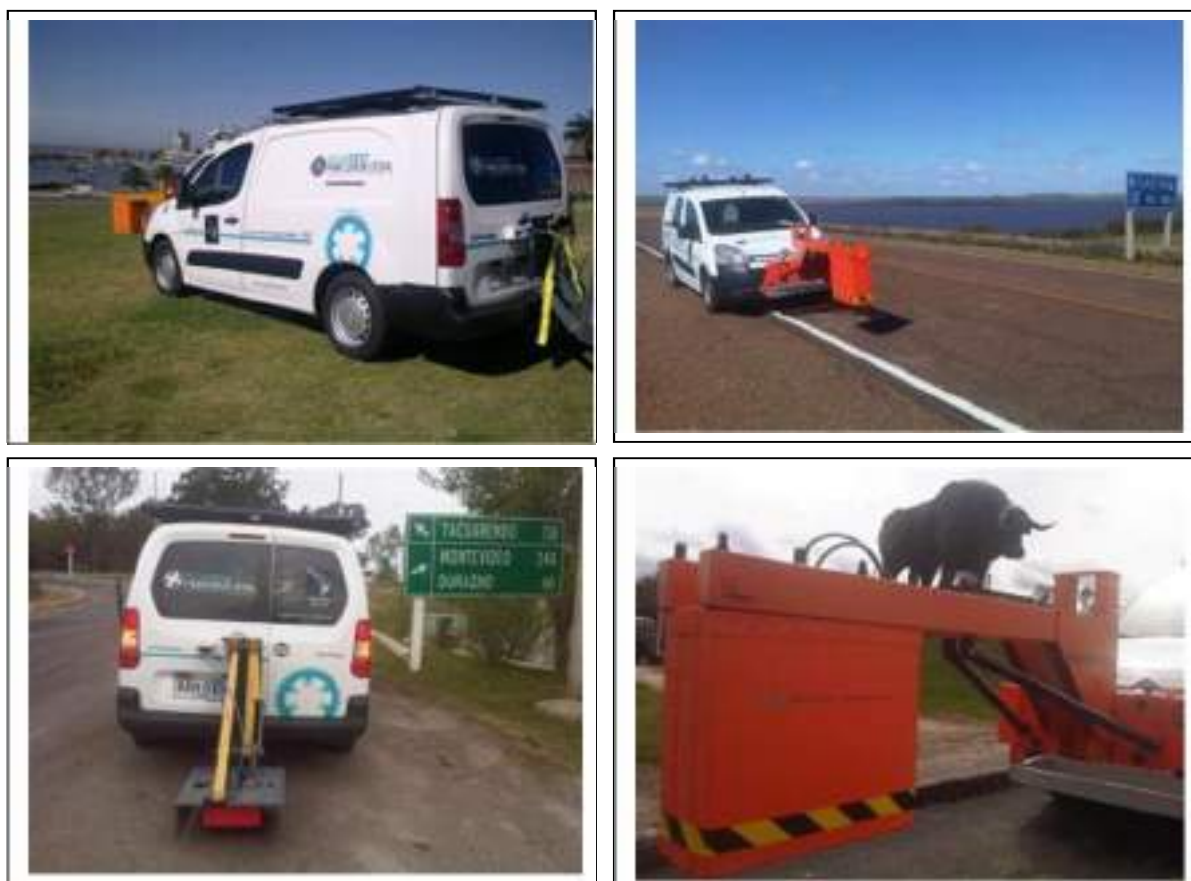
Ilustración 12 – VEHÍCULO CON RADAR PENETRANTE DE TIERRA
