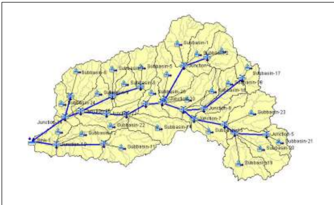
Figura 2-8 Configuración semidistribuida del modelo hidrológico
