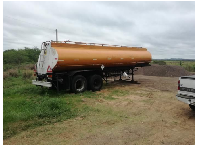
Foto 13.1-1 Tanques de asfalto sin dique de contención
