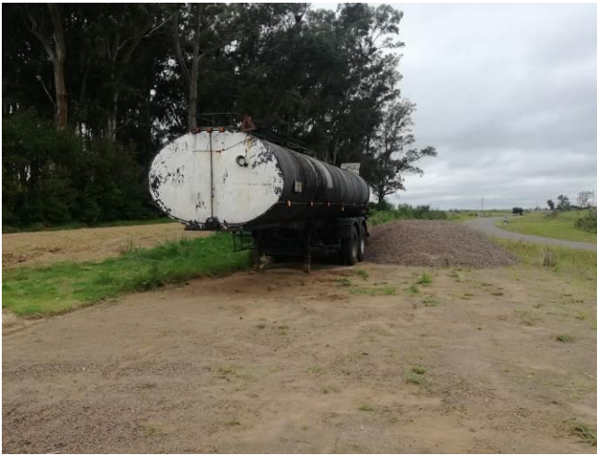
Foto 13.1-1 Tanques de asfalto sin dique de contención
