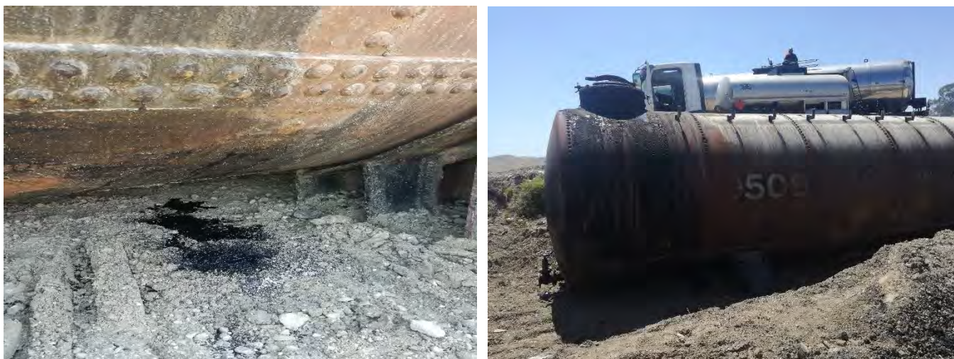
Foto 13.5-1 NC 3 - Tanques de asfalto sin dique de contención obrador Días Álvarez
