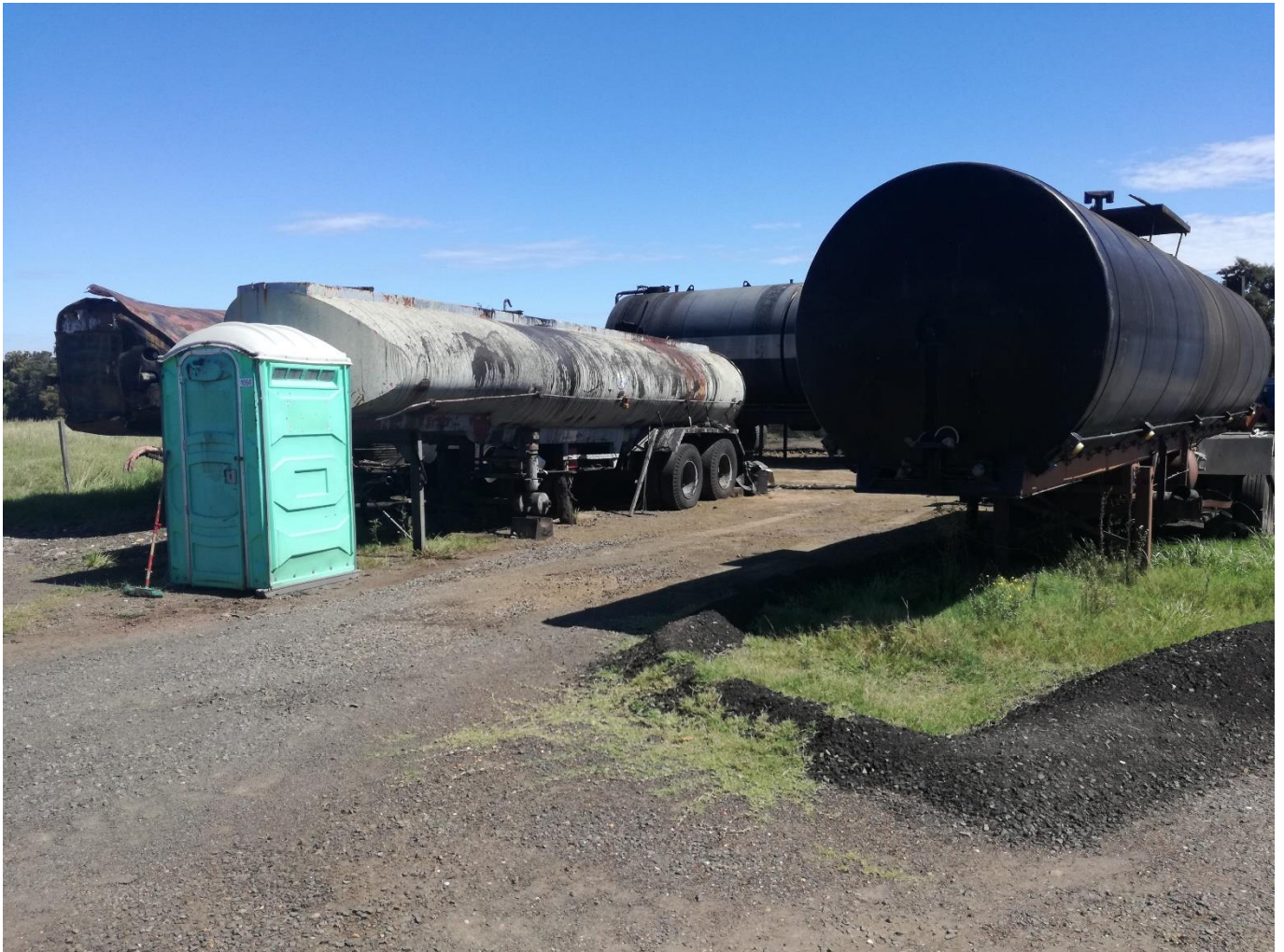
Foto 13.1-1 Tanques de asfalto en obrador
