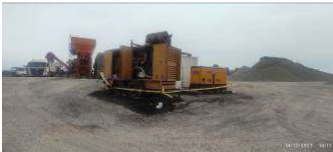
Foto 12.3-1 Diques de contención inadecuados.
