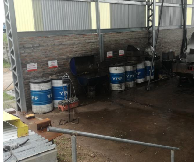
Foto 18 Depósitos para separación de residuos contaminados
