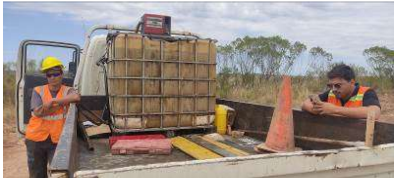
Foto 13.1-1 Tanque de combustible sin bandeja de contención.
