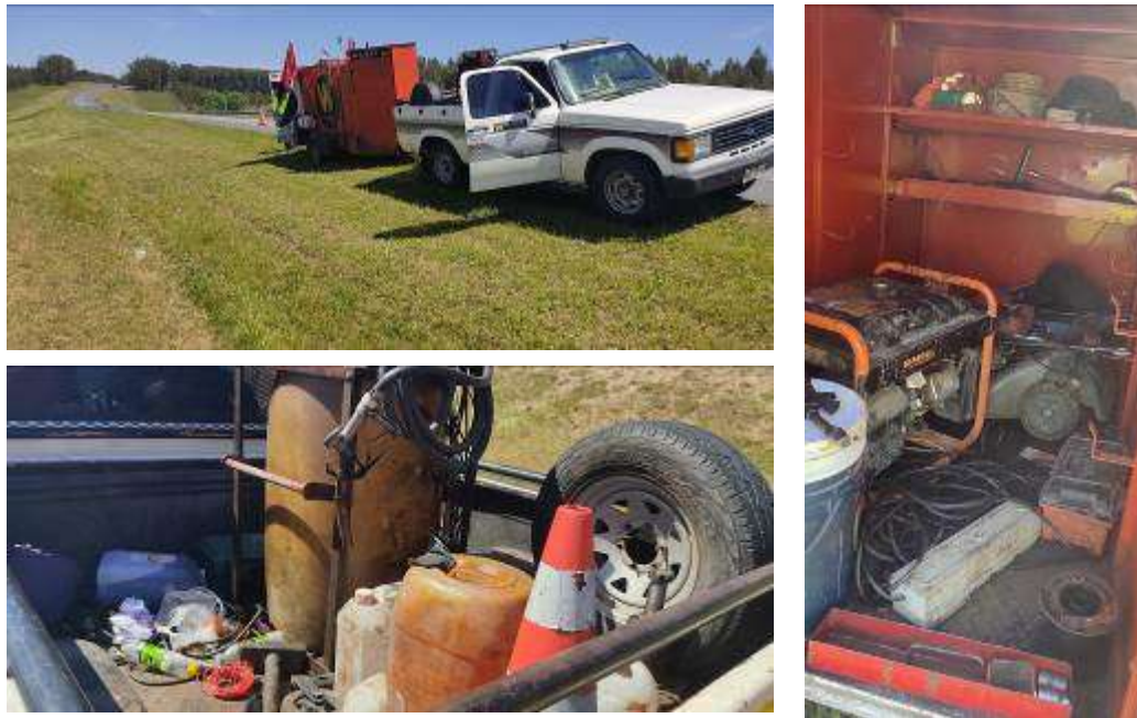
Foto 13.2-1 Contenedores de combustibles en lugares no estancos.
