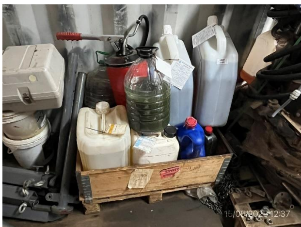
Foto 12.1-5, P03. Pañol, se encuentran bidones con aceite y combustibles en sector techado, pero sin envallar.
