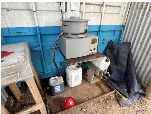
Foto 12.1-3, P03. Laboratorio de asfaltos, acopio de percloroetileno en sector envallado y techado
