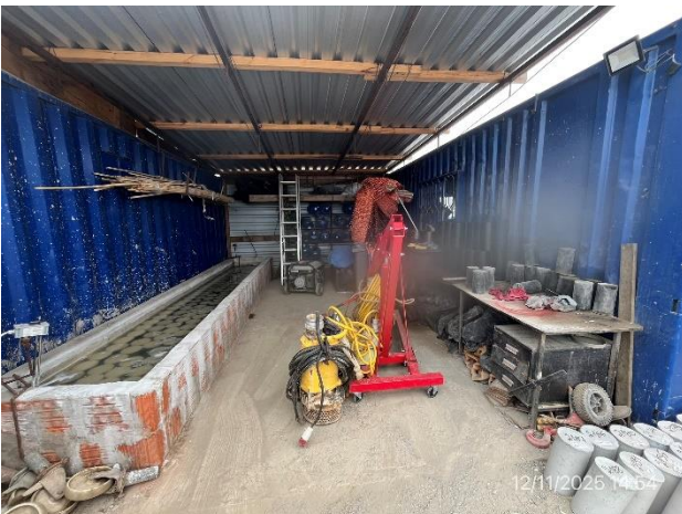
Foto 12.3-5, P03. Laboratorio de hormigón, acopio de probetas. Buenas condiciones de orden y limpieza.
