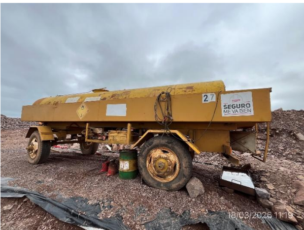
Foto 12.1-23, P06. Cisterna de combustible con zócalo perimetral estanco para contención de derrames.
