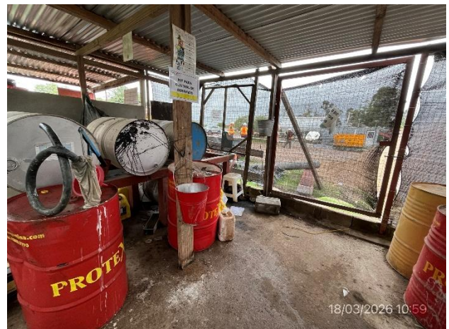
Foto 12.1-6, P03. Acopio de lubricantes y productos químicos en local techado y envallado.
