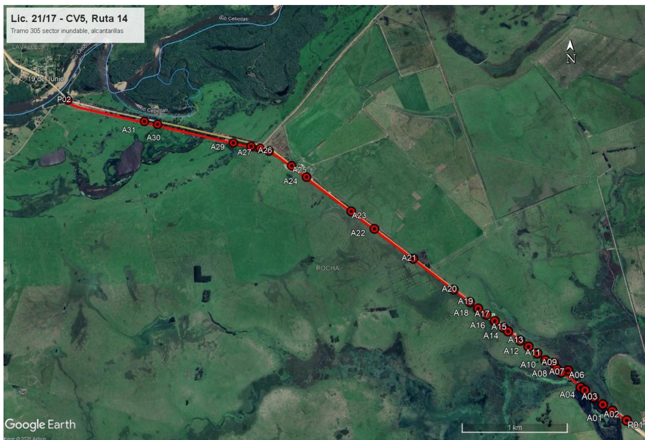
Figura 5-2. Alcantarillas a construir en tramo inundable.
