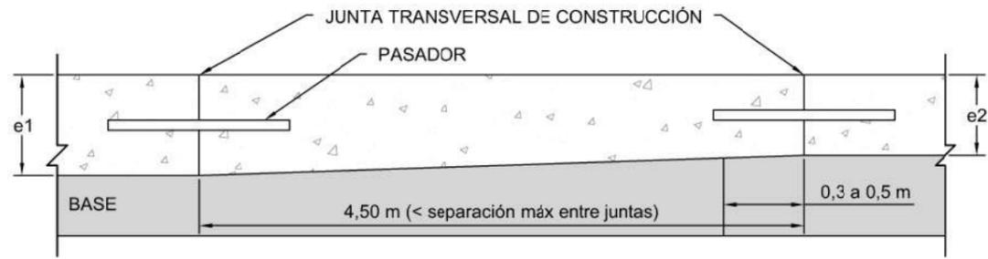
**PAVIMENTOS DE HORMIGÓN SIMPLE DE DISTINTO ESPESOR**
