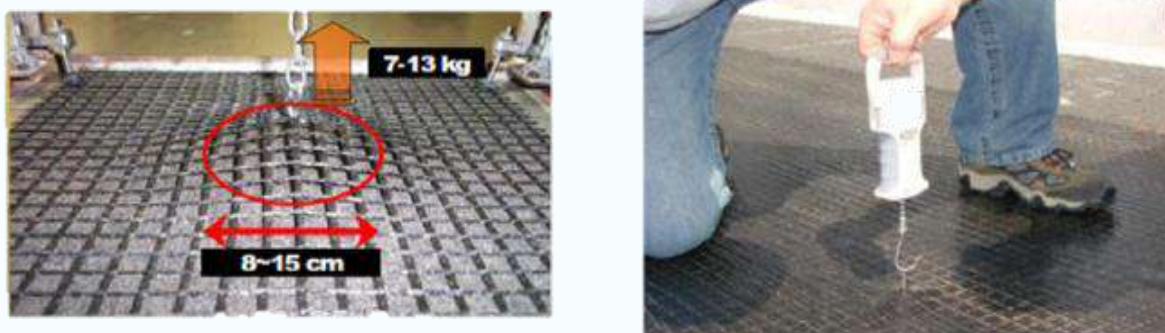
Foto 3. esquema de realización del ensayo de adherencia.
