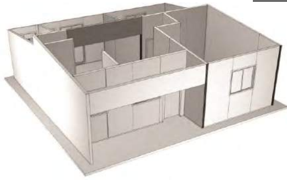
Panel viga: Calado de los muros laterales para insertar el panel horizontal
