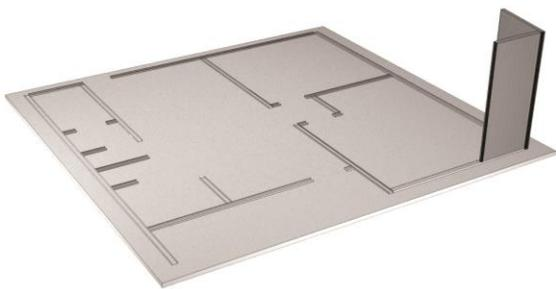
Colocación de muros exteriores. Comenzamos por la esquina, para ir rigidizando la estructura.
