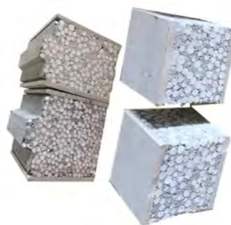
Estos paneles, uno de cuyos lados es “macho” y el otro lado “hembra”, se fijan entre sí mediante adhesivos y refuerzos metálicos, a la fundación a través de adhesivo cementicio y auxiliado por perfiles U metálicos (que contribuyen al posicionado y replanteo), y el encadenado superior también con perfiles U metálicos pero continuos.
