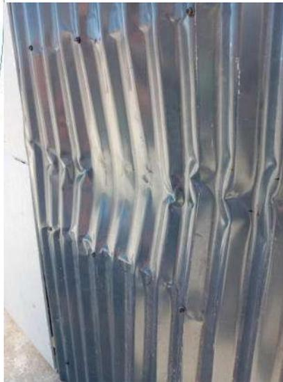
Figura N°5. Abolladura en chapa de fachada ventilada energía de impacto de 960J
