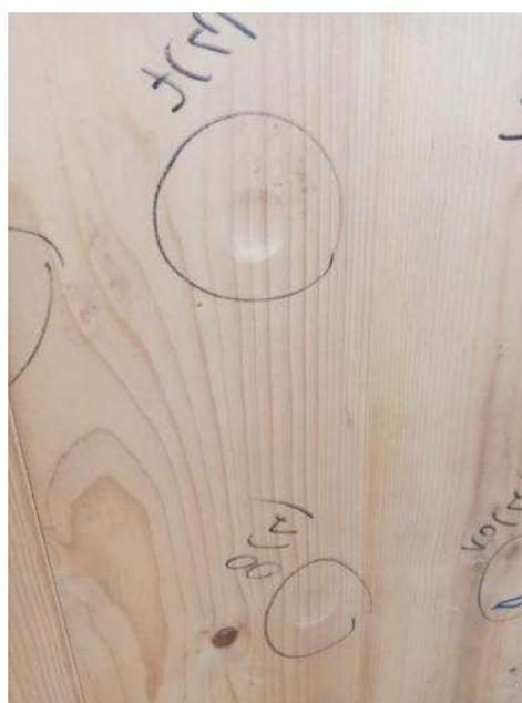
Figura N°9. Tipo de daños producidos en la madera contralaminada luego del ensayo de impacto de cuerpo duro con una energía de impacto de 20 J.
