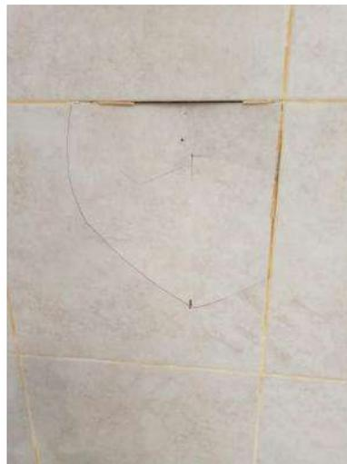
Figura N°3. Daño en cerámica luego de impacto con una energía de 180 J
