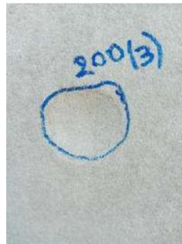
Figura N°7. Daños provocados por ensayo impacto cuerpo duro con la esfera de 1 kg
