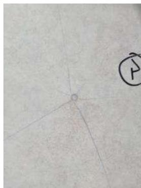
Figura N°8. Fisuras superficiales luego de ensayo de impacto cuerpo duro con una energía de 10 J
