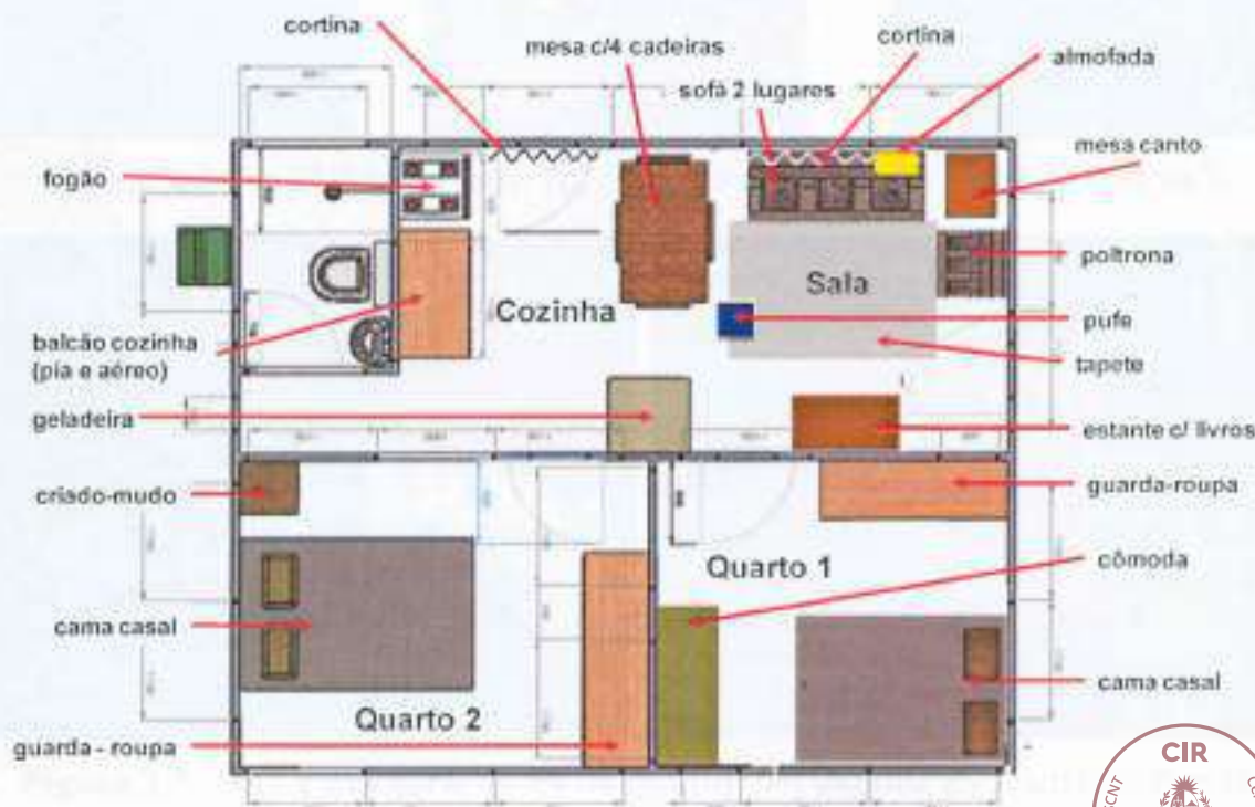
Figura 3.3 – Desenho esquemático da mobília do protótipo
