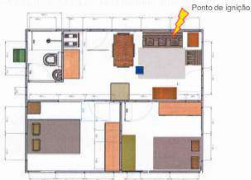
Figura 3.17 – Posição do ponto de ignição do incêndio
