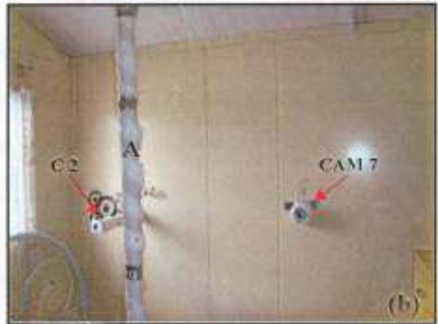
Figura 3.12 – (a) Árvores de termopares sala/cozinha (B) e quarto 2 (C); (b) Quarto 1, com árvore de termopares (A), câmera CAM 7 e coleta dos gases C2.
