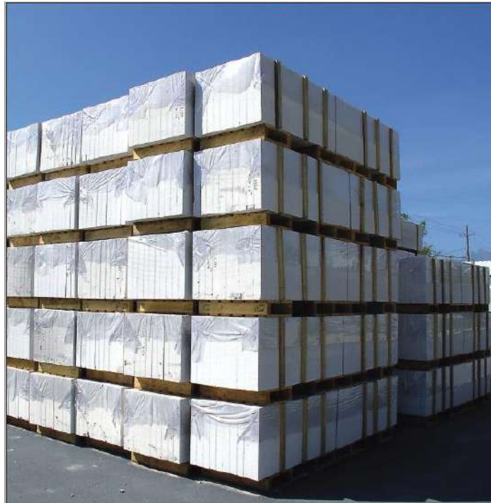
FIGURA11. IMAGEN REFERENCIAL DE ALMACENAJE DE PANELES Y BLOCK DE HORMIGON CELULAR.
