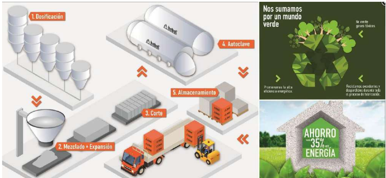
FIGURA7. DESCRIPCION DE FABRICACION HORMIGON CELULAR.
