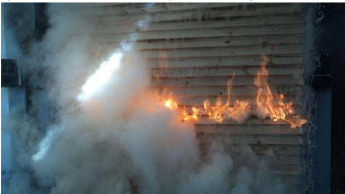
Figura 3.8: Muro M-2x4-11-MM durante el ensayo de resistencia al fuego.
