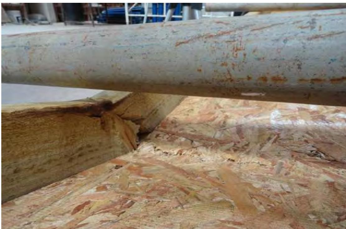
Figura 2.25: Modo de falla característico de ensayo de flexión en muros con estructura de madera con la carga aplicada en la cara con placa arriostrante.
