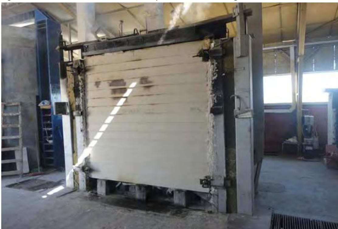
Figura 3.6: Muro M-2x4-9-YF durante el ensayo de resistencia al fuego.
