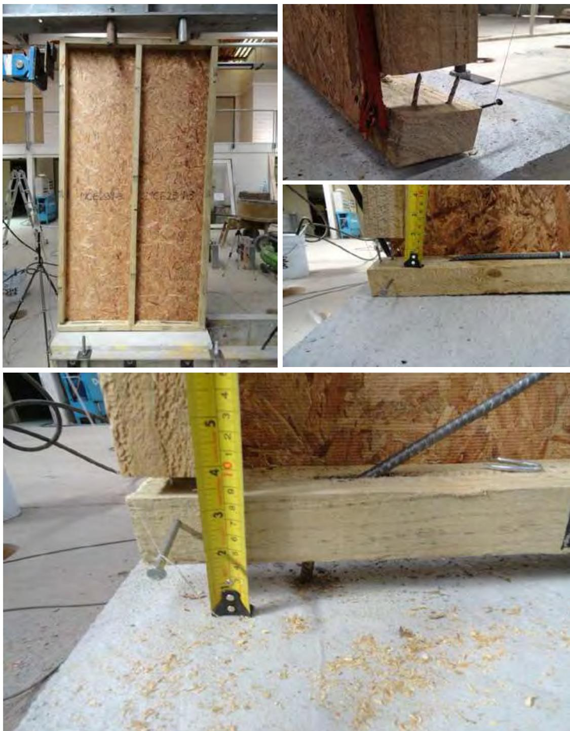
Figura 2.18: Modo de falla característico de ensayo de carga horizontal en muros con estructura de madera con sistema de anclaje perno y escuadra.
