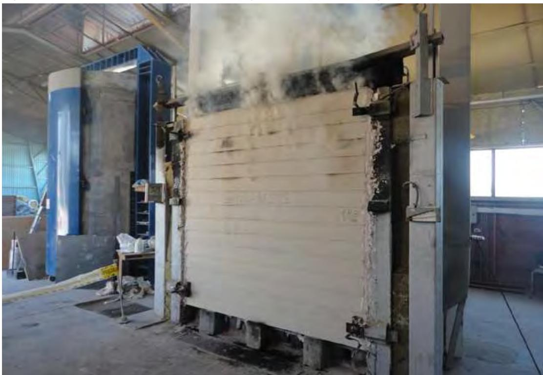
Figura 3.7: Muro M-2x3-11-MM durante el ensayo de resistencia al fuego.
