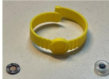
3.3.2. Dosímetro de extremidad desarmado, el detector se muestra a la izquierda.
