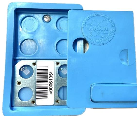
3.2.2. Dosímetro abierto, con detector (TLD) dentro.
