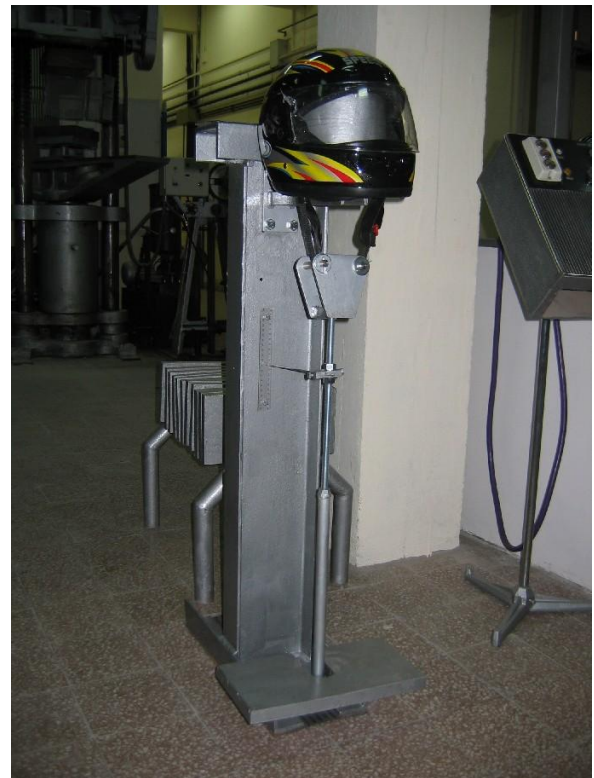
Fig. 7 – Ensayo de la sujeción
