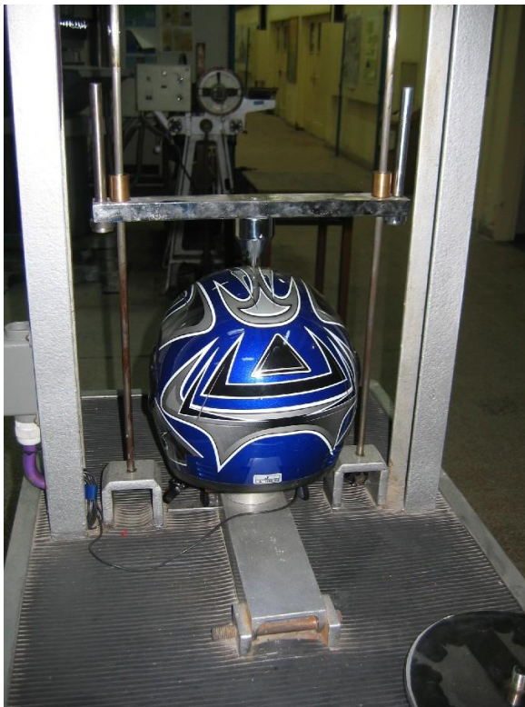
Fig. 6 – Ensayo de penetración
