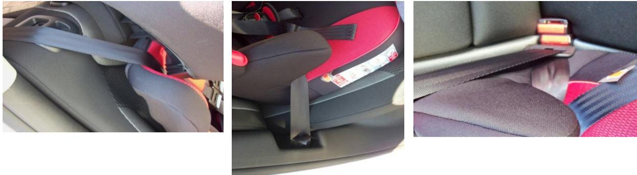
*No se debe superponer ni combinar los sistemas de anclaje, se deberá utilizar solamente aquel que el vehículo disponga para anclar el sistema de retención infantil al asiento trasero (cinturón de 3 puntos retráctil, ISOFIX o LATCH)*
