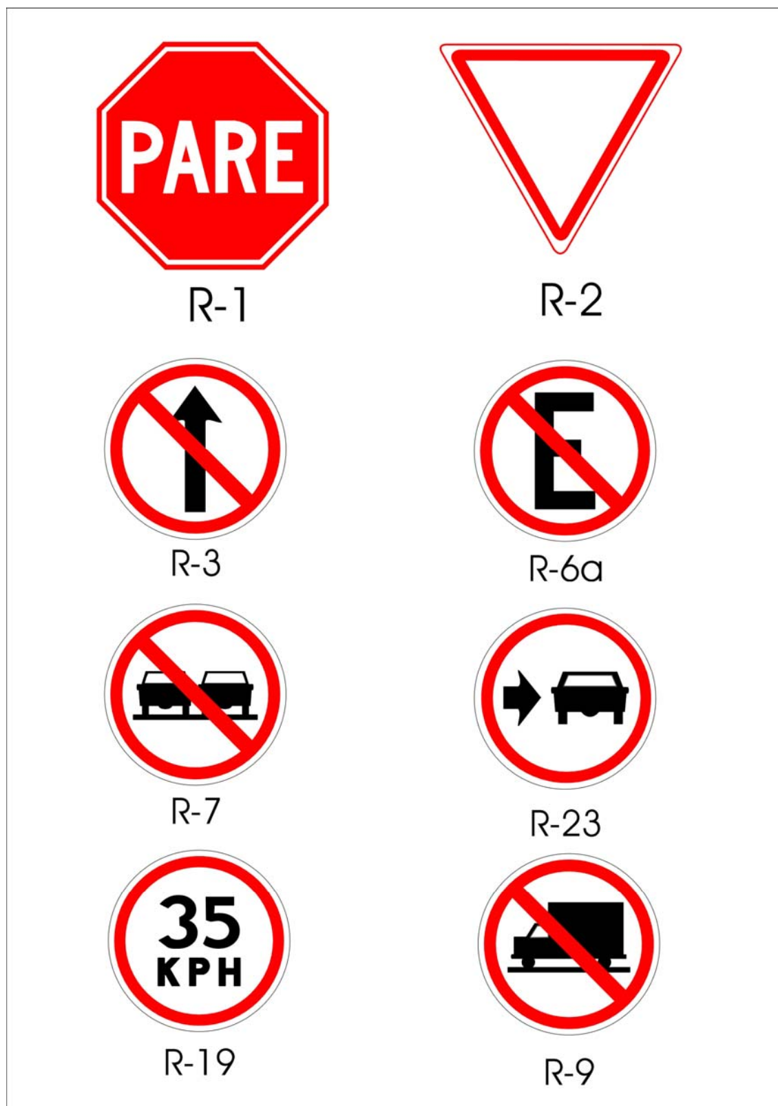
FIGURA 6.12. Señales de Reglamentación de uso más frecuente En zonas donde se ejecutan trabajos.
