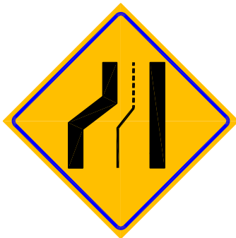
OP-21c ESTRECHAMIENTO DE CALZADA POR LA IZQUIERDA
