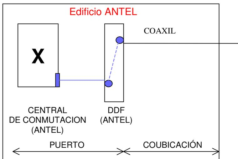
AMWU implementa, entre el distribuidor digital (DDF) de su propio local y el DDF del local de ANTEL donde se brinda la interconexión, el cable coaxial necesario para el enlace.
