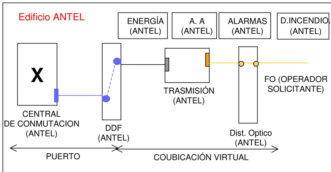
AMWU implementa el cable de fibra óptica necesario para el enlace, entre el DO (Distribuidor Óptico) de su propio local y el DO del local de ANTEL donde se brinda la interconexión.
