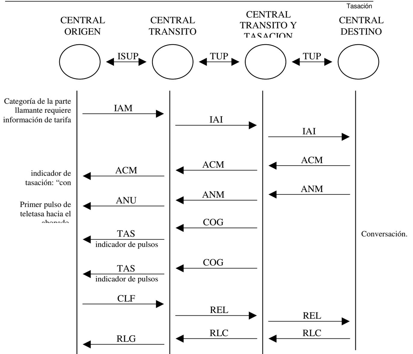
Fig. 2.3 - Interfuncionamiento ISUP > TUP.
