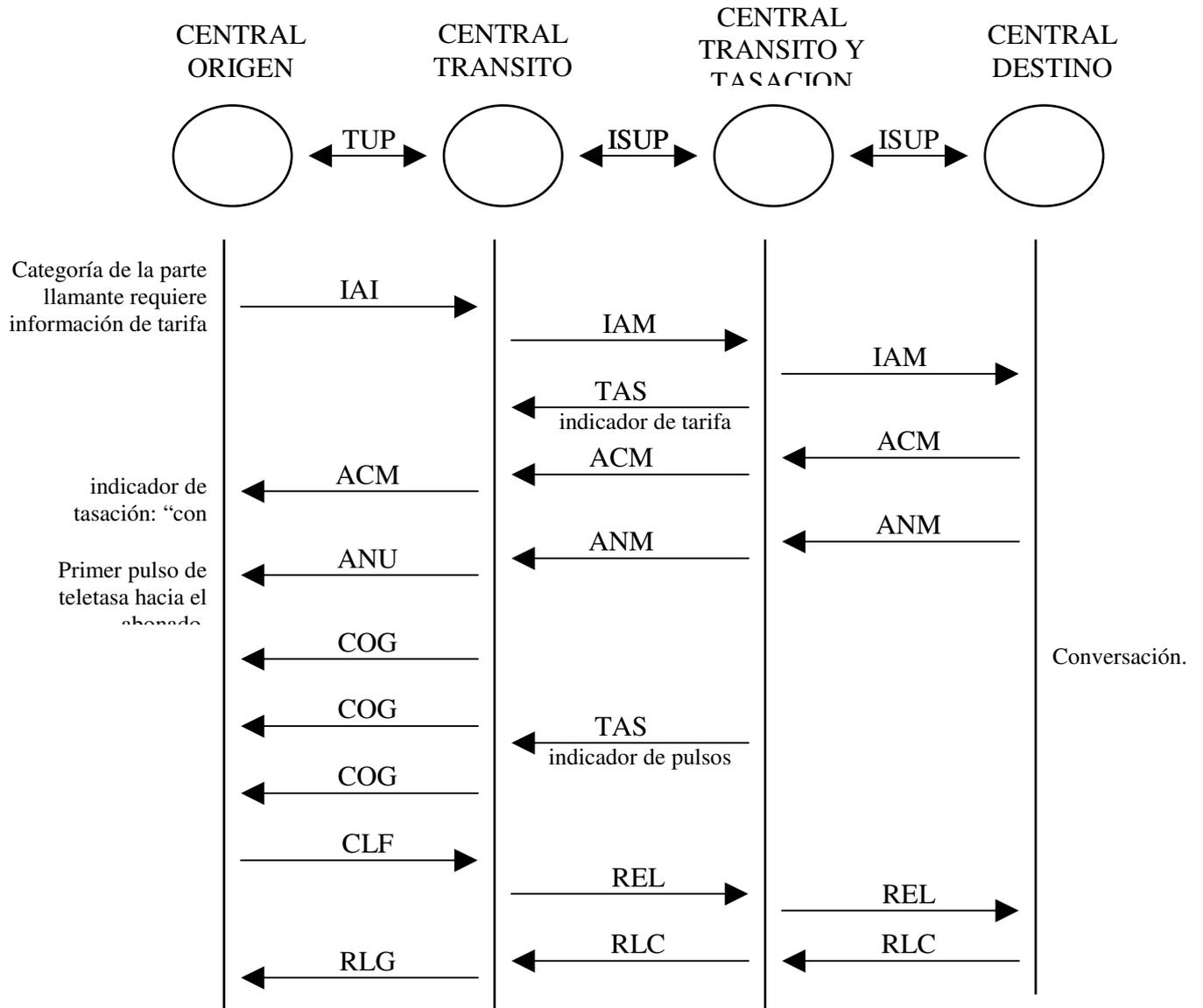
Fig. 2.2 - Interfuncionamiento TUP > ISUP.
