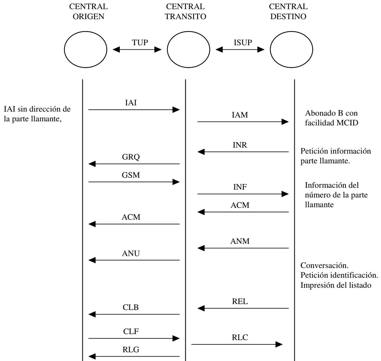
Fig. 3.2 - Interfuncionamiento TUP > ISUP
