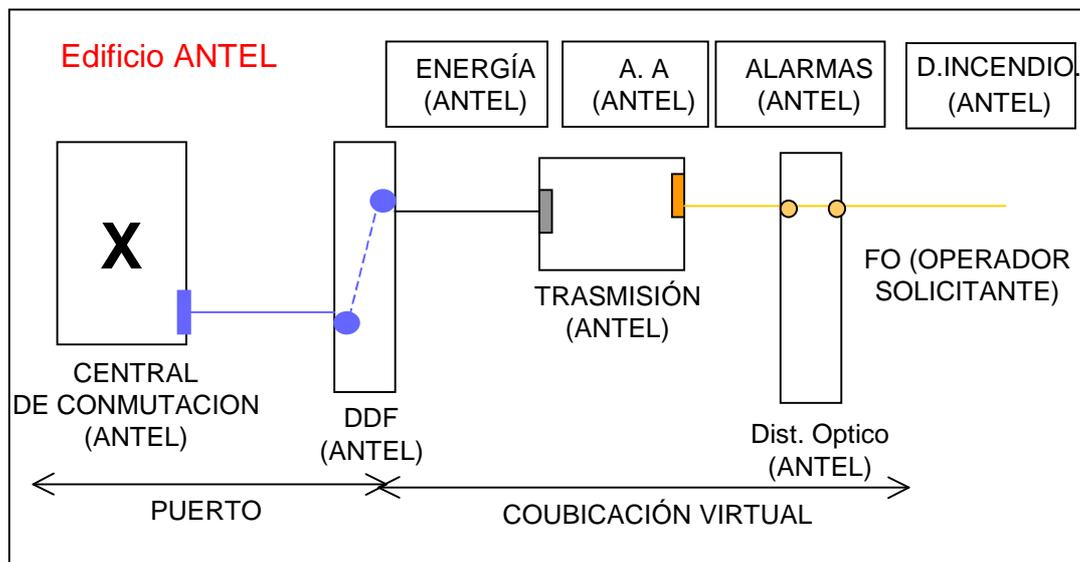
ABIATAR implementa el cable de fibra óptica necesario para el enlace, entre el DO (Distribuidor Óptico) de su propio local y el DO del local de ANTEL donde se brinda la interconexión.
