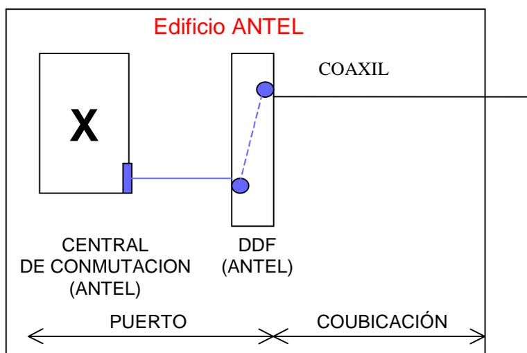
ABIATAR implementa, entre el distribuidor digital (DDF) de su propio local y el DDF del local de ANTEL donde se brinda la interconexión, el cable coaxial necesario para el enlace.
