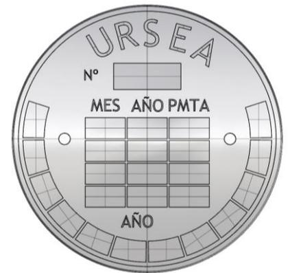
Figura 1: Esquema de la Placa de Registro del Generador de Vapor
