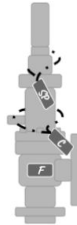
fig. b Válvula de seguridad con placas de fabricación (F) y Calibración (C).
