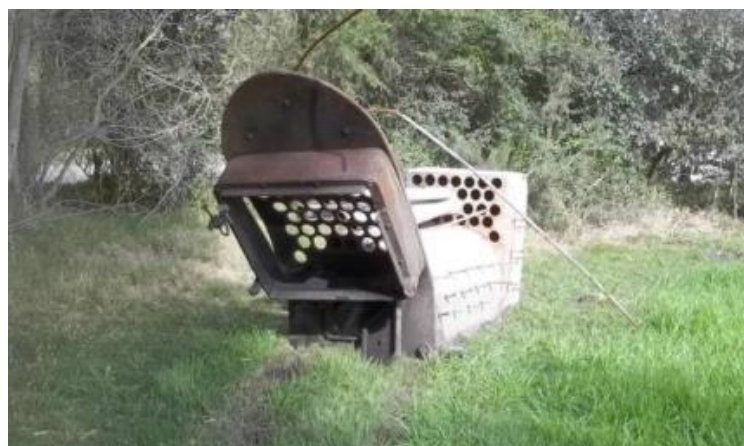
Generador de Vapor retirado de Sala de Generación de Vapor luego del accidente
